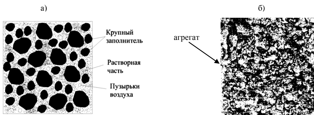
Рис. 2. Макроструктура (а) и микроструктура (б) бетонной смеси
